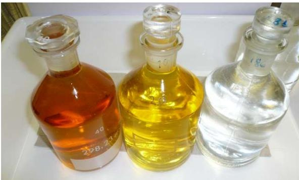
Abb. 3 Mit Schwefelsäure aufgelöster Niederschlag. Von links nach rechts: übersättigte Probe ist sehr dunkel, Niederschlag braucht 10-15 min zum Auflösen, leicht untersättigte Probe, sauerstofffreie Probe (muss nicht titriert werden).
