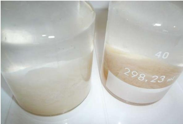
Abb. 2 Niederschlag nach Zugabe von Winkler I und II. Linke Probe ohne Sauerstoff (entspricht der Reaktion NUR mit Winkler I). Rechte Probe stark untersättigt (ca. 40%). Je mehr Sauerstoff enthalten war, desto dunkler wird der Niederschlag.
